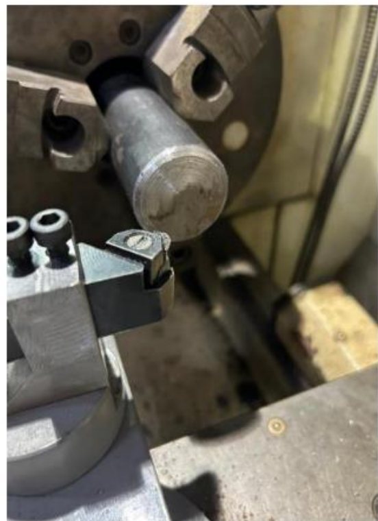
Figura 2 - Utilizando o dispositivo para usinagem circular
