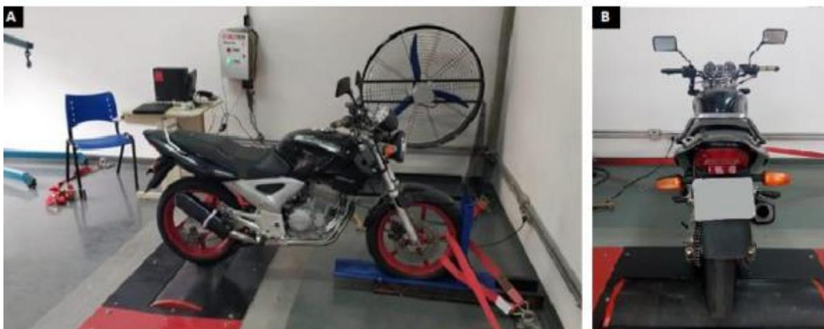
Figura 39 - Em (A) motocicleta preparada para o ensaio totalmente em equilíbrio devido ao suporte da roda dianteira e sem nenhum outro apoio. Em (B) detalhe do posicionamento da roda traseira sobre o rolo do dinamômetro.
